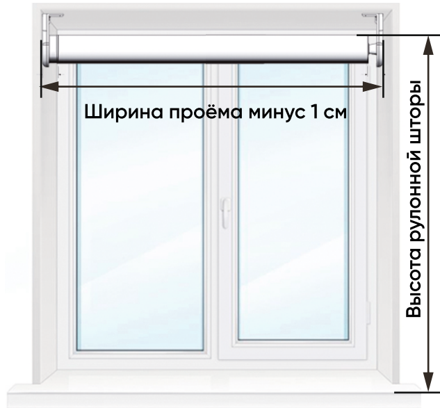
Монтаж карниза в проём окна
