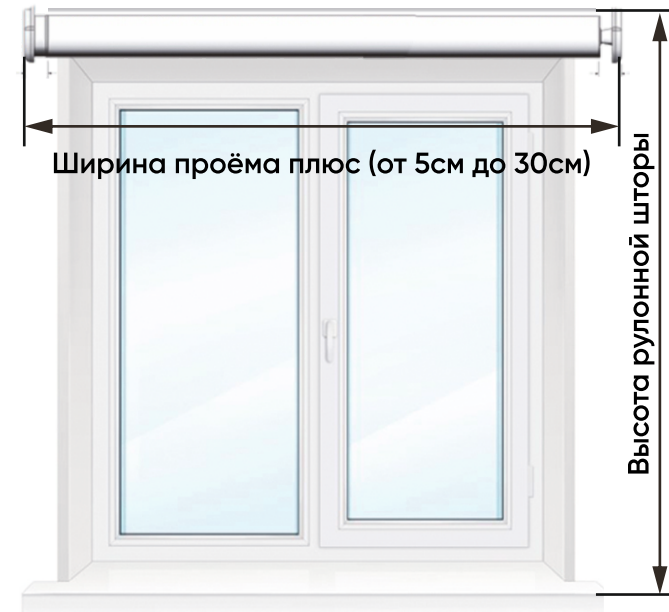
Монтаж карниза над проёмом окна
